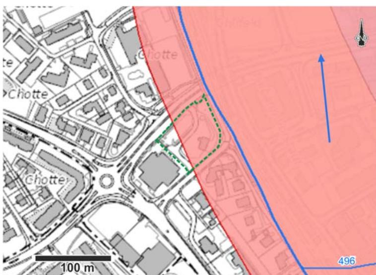
**Abb. 1** Ausschnitt aus der Gewässerschutzkarte des Kantons Luzern, Massstab 1:5'000. Kartengrundlage © Geoinformation Kanton Luzern 2020. Rötliche Signatur: Gewässerschutzbereich Au. Blaue seitliche Linien: Grundwasserberandung bei Mittelwasserstand. Blauer Pfeil: ungefähre Grundwasserfliessrichtung. Grün gestrichelt: Ungefäher Projektperimeter.
