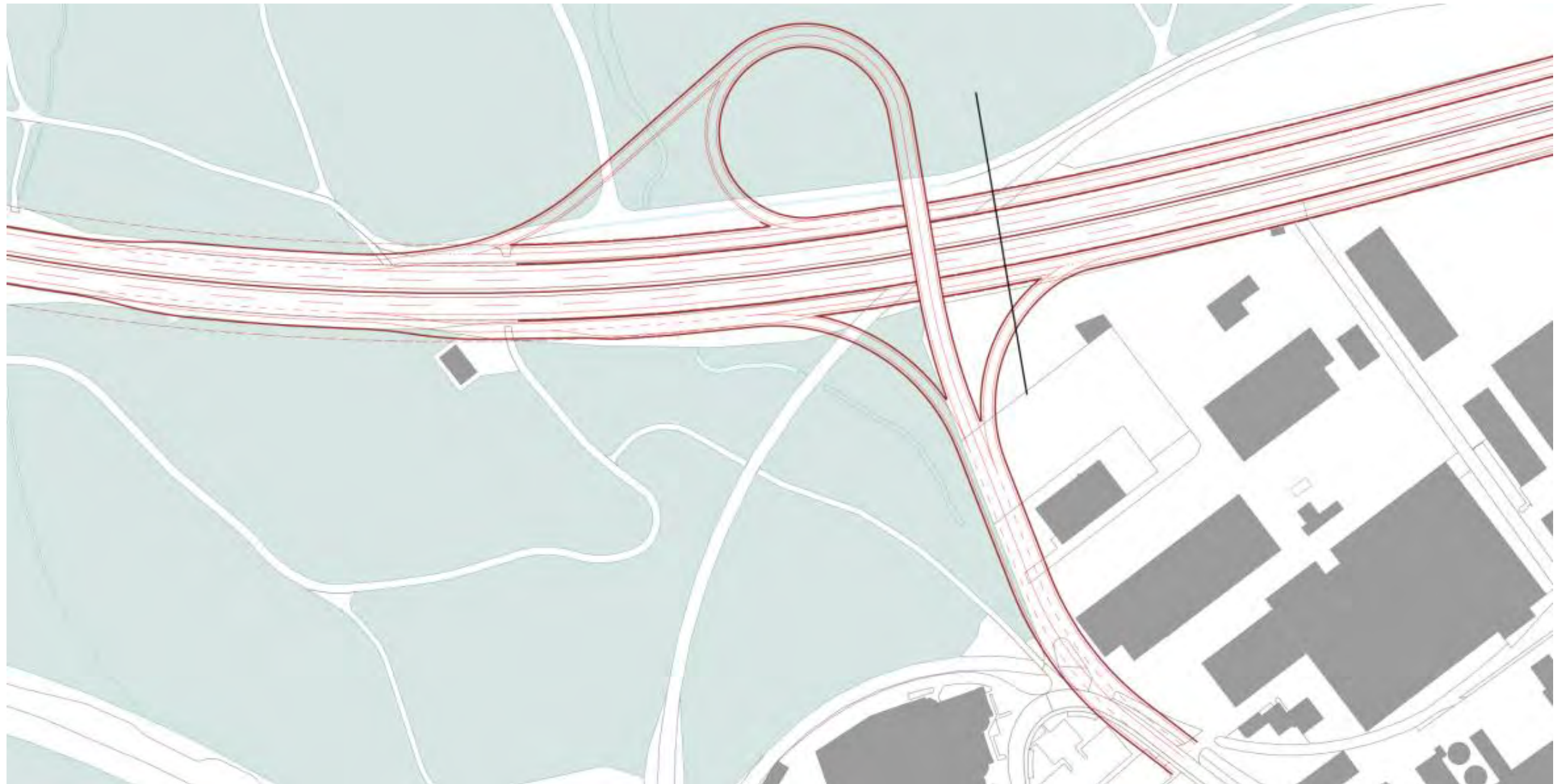
Abbildung 84: Skizze Platzbedarf und Lichtraumprofil Autobahnanschluss Variante 4.1a
