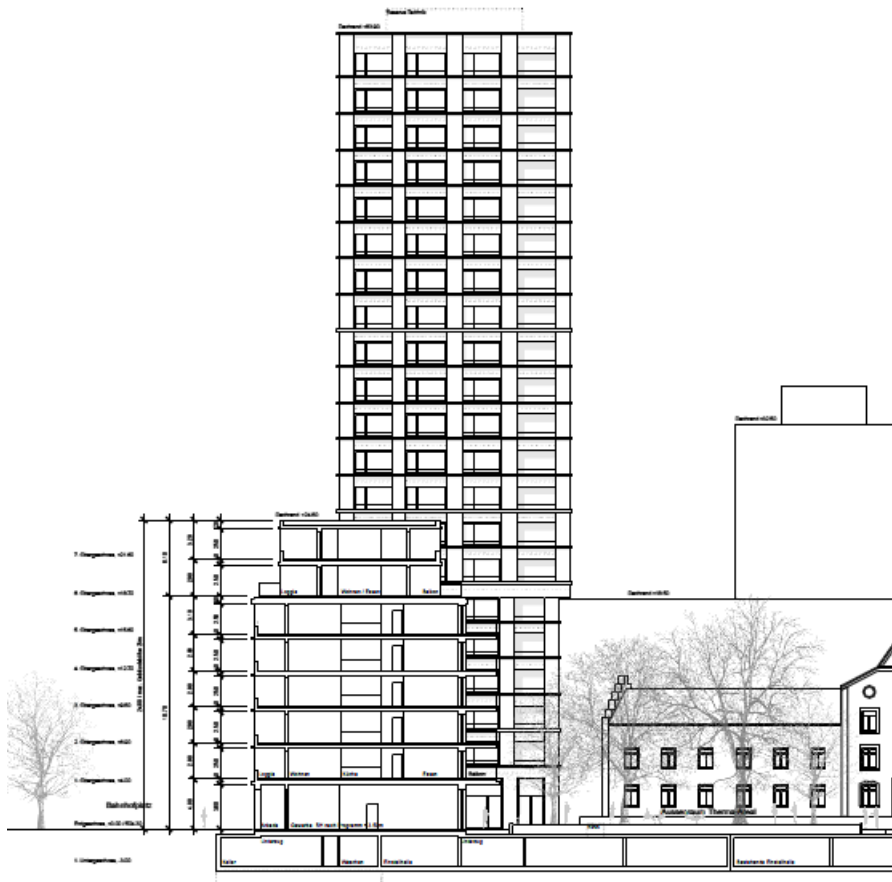
Abbildung 10: Schnitt Längsbau/ Südansicht
